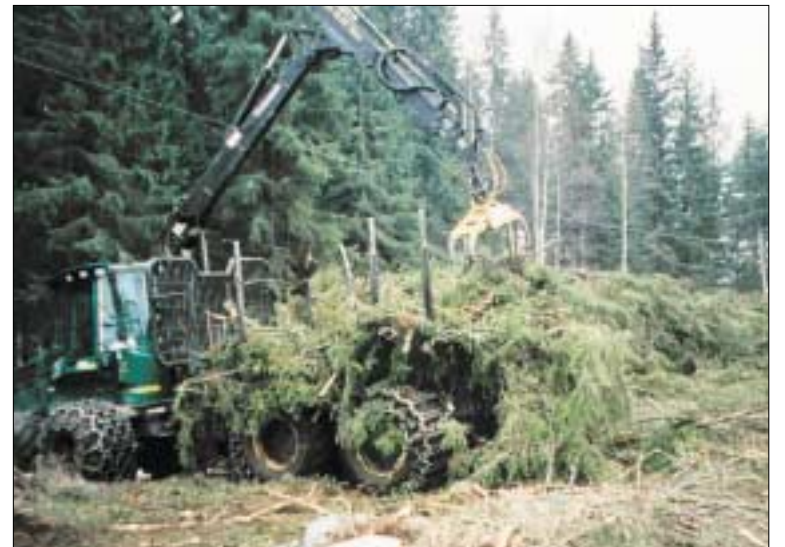
Tässä korjataan Palojoella hakkuutähteitä aumaan. Haketin tekee siitä silppua paikan päällä.
